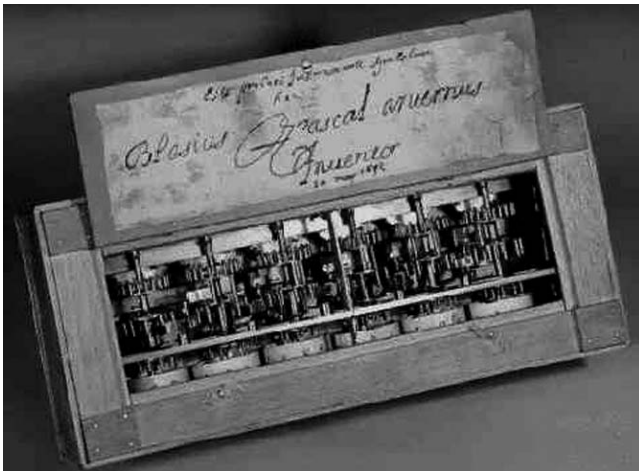
Fig. 2. Pascaline invented in 1642 by Pascal (Conservatoire National des Artes et Metieres de Paris)
