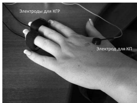
Рис. 2. Расположение электродов на левой руке испытуемого
