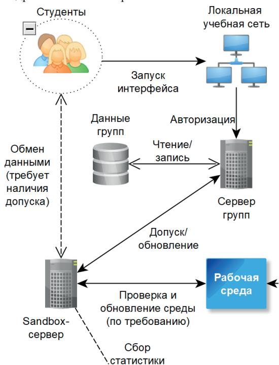
Рис. 2. Набор компонентов, соответствующий элементу «Локальная учебная сеть» на общем графическом представлении схемы компонентов
