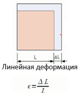
Рис. 7. Схематическое изображение того, как выглядит и выражается линейная деформация
