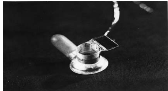
Рис. 4. Слева — схематическое изображение глазной присоски с фотоэлектрическим датчиком для регистрации торзионных движений глаз:
