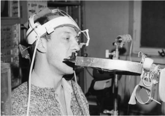
Рис. 5. На фотографии аппаратные средства регистрации ТДГ и наклонов головы (гониометр) показаны в рабочем положении
