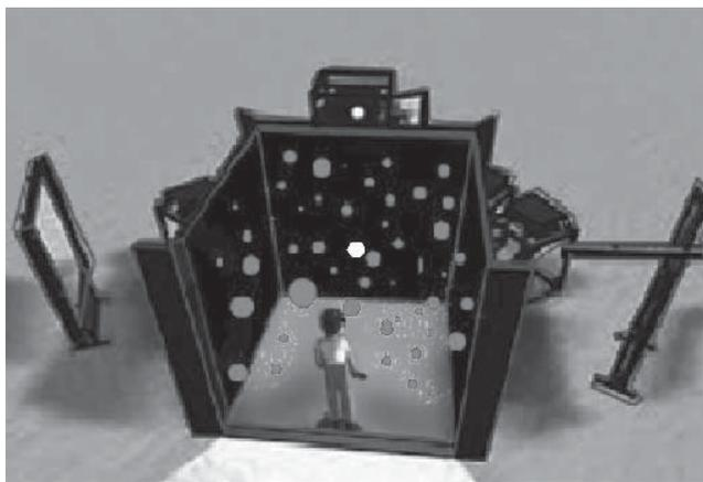
Рис 1. Общий вид экспериментальной установки виртуальной реальности CAVE-system
