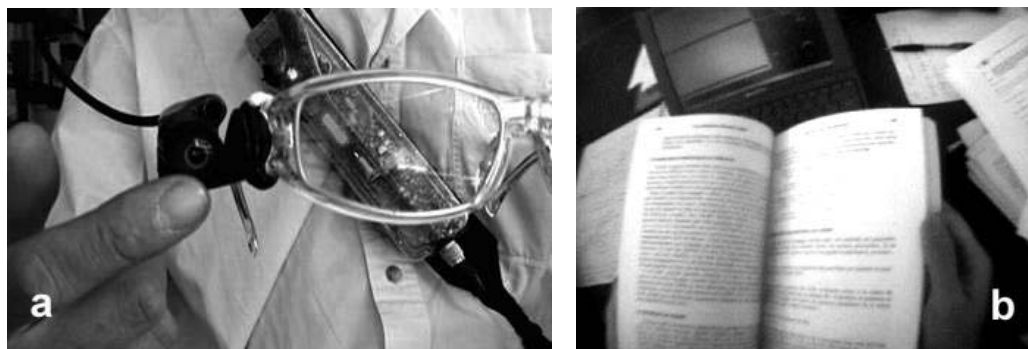
Рис. 1. Один из первых прототипов (1997) SubCam на очках (а) и типичный кадр из видеозаписи, сделанной при помощи SubCam (b)
