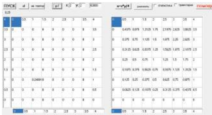
Рис. 5. Расчет значения функции u(x, y) для внутреннего узла (ячейки) x=2, y=2 Fig. 5. Calculation of the value of the u(x, y) function for the internal node (cell) x=2, y=2
