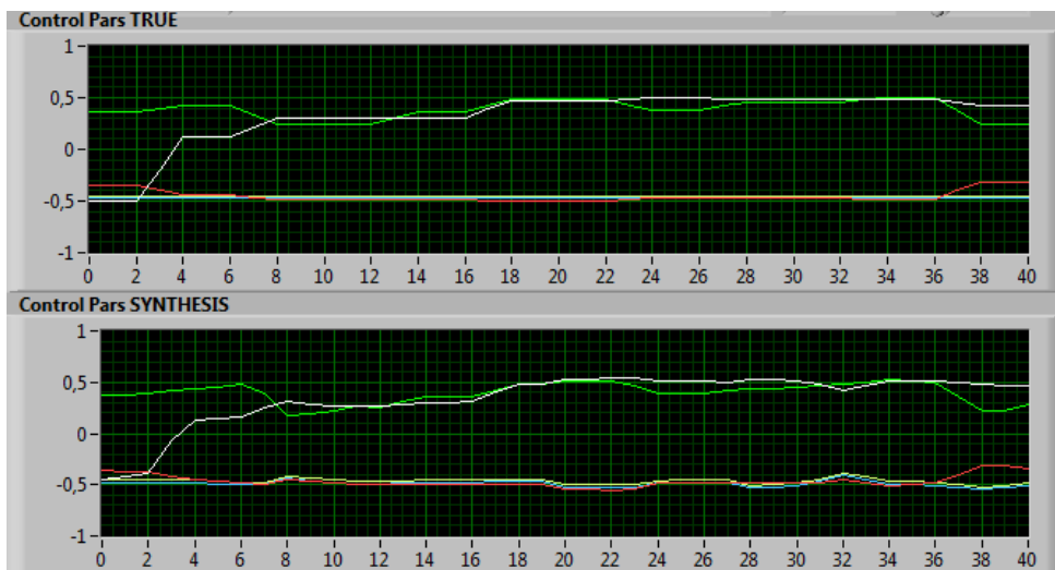
Рис. 6. Фрагмент управления ВС в выбранном посредством ISFA паттерне (Control Pars TRUE) и синтезированный посредством ISFS «восстанавливающий» фрагмент управления ВС (Control Pars SYNTHESIS) продолжительностью 32 с (указанные фрагменты располагаются с 4-й по 35-ю секунду, 4 параметра управления ВС)
