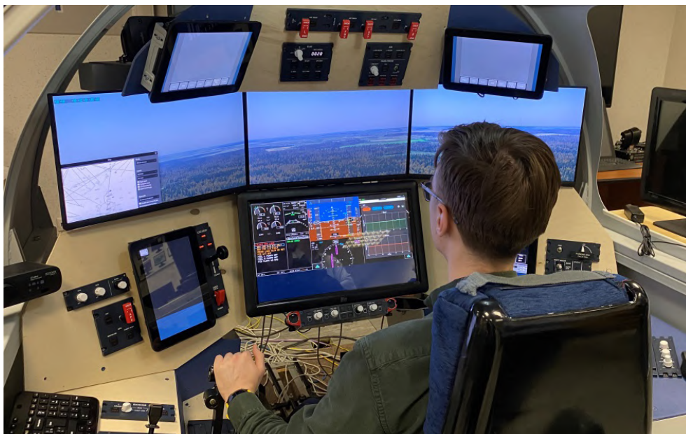
Рис. 1. Комплексный демонстратор технологий интеллектуального «виртуального второго пилота»
