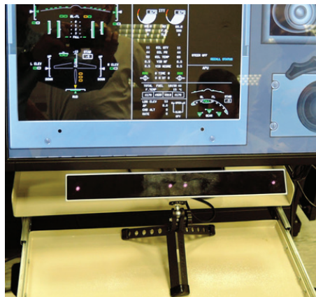
Рис. 3. Айтрекер Gazerpoint GP3 (Gazerpoint Research Inc.), с помощью которого регистрировались данные видеоокулографии
