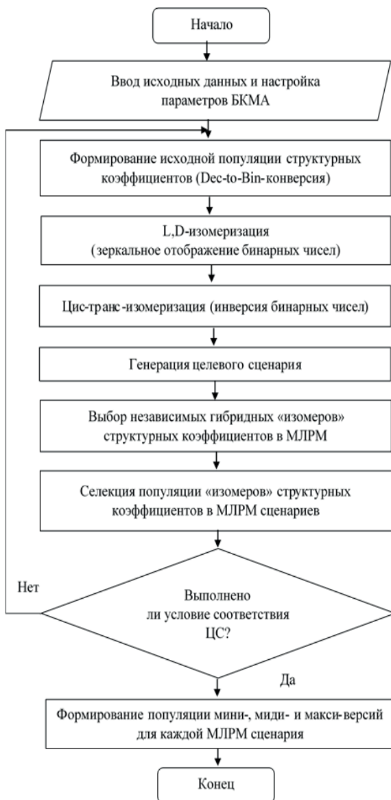
Рис.2. Структурная схема биоинспирированного алгоритма формирования, изомеризации, гибридизации и селекции прогнозных сценариев динамики вариационных рядов.
