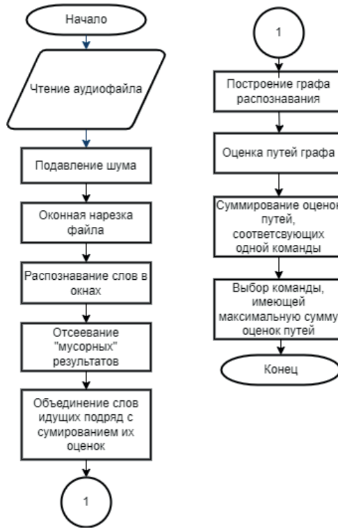
Рис. 7. Блок-схема алгоритма распознавания речи
